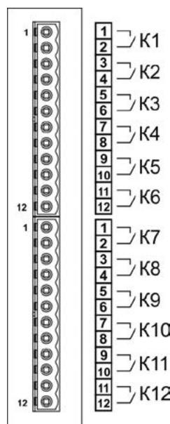
12-канальный модуль дискретных входов (тип модуля «Д12»)
