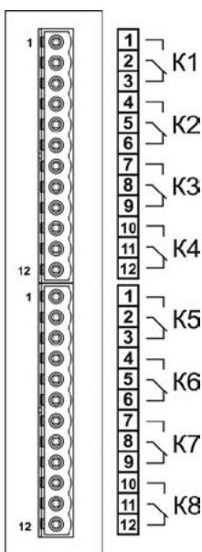
12-канальный модуль твердотельных реле (тип модуля «TR12»)
